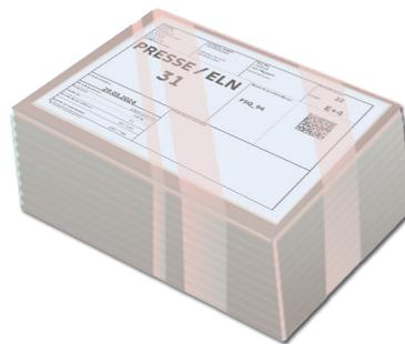
Abb. 26b: Bundfertigung mit Folierung
