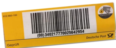
Beispiel für ein NVE-Label, das im Rahmen der Entgeltsicherung für die DIALOGPOST aufgeklebt wird und bei Paletteneingang und -auflösung gescannt wird
